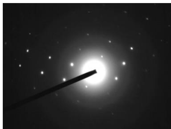
Рис. 5 б. Моноклінна модифікація решітки графіту
